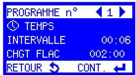
Sélection du mode de prélèvement TEMPS
